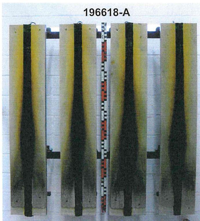
Bild 3: Aussehen des Probekörpers nach 10-minütiger Beflammung
